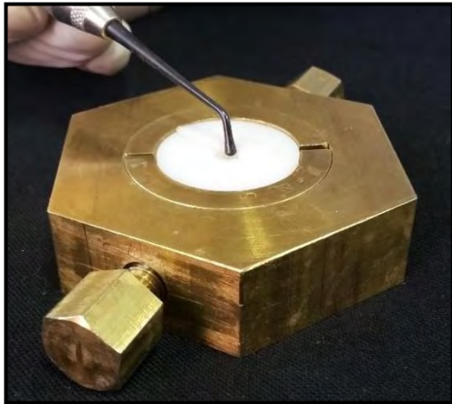
Figura 12. Obturación del orificio con resina
