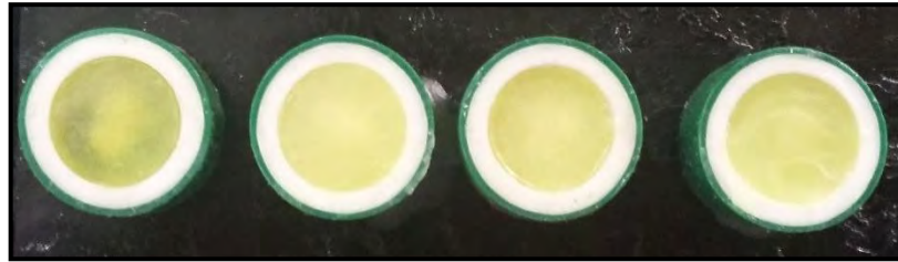
Figura 3. Acrílico vertido dentro de los anillos de PVC
