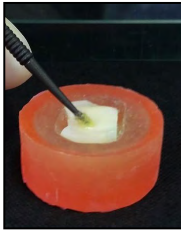
Figura 16. Colocación del adhesivo
