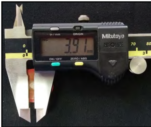
Figura 23. Obtención del diámetro con vernier digital
