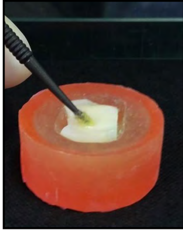
Figura 21. Colocación del adhesivo
