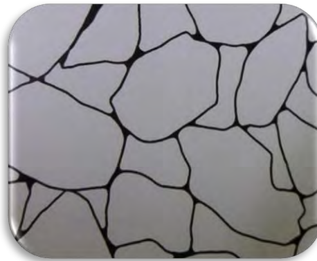
Figura 16 Esquema de sinterización en fase inicial de cerámica policristalina con formación de puentes entre granos y presencia de canales y poros.
