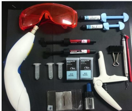
Fig.11 Material utilizado para la conformación de muestras de resina. Fuente directa del Laboratorio de Materiales Dentales de DEPeI.
