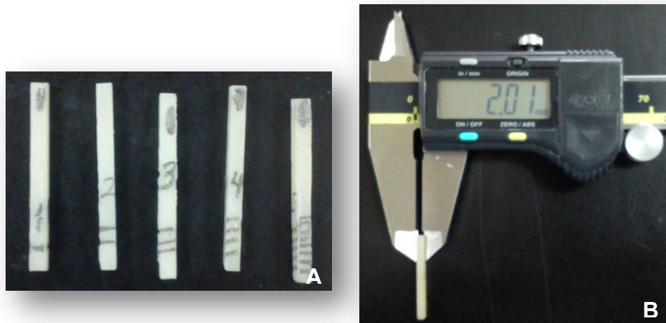
Fig.22-A y 22-B. Toma de medidas con vernier de alta precisión de cada resina de cada uno de los grupos. Fuente directa del Laboratorio de Materiales Dentales de DEPel.
