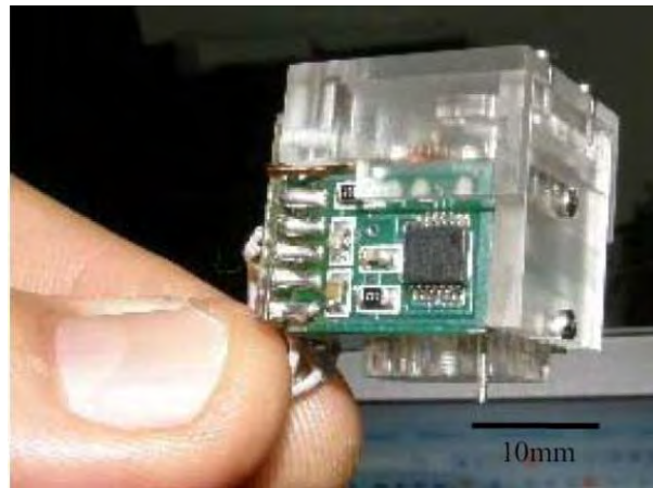
Figura 16. Microdrive basado en motor a pasos (CCADET 2009) [40].
