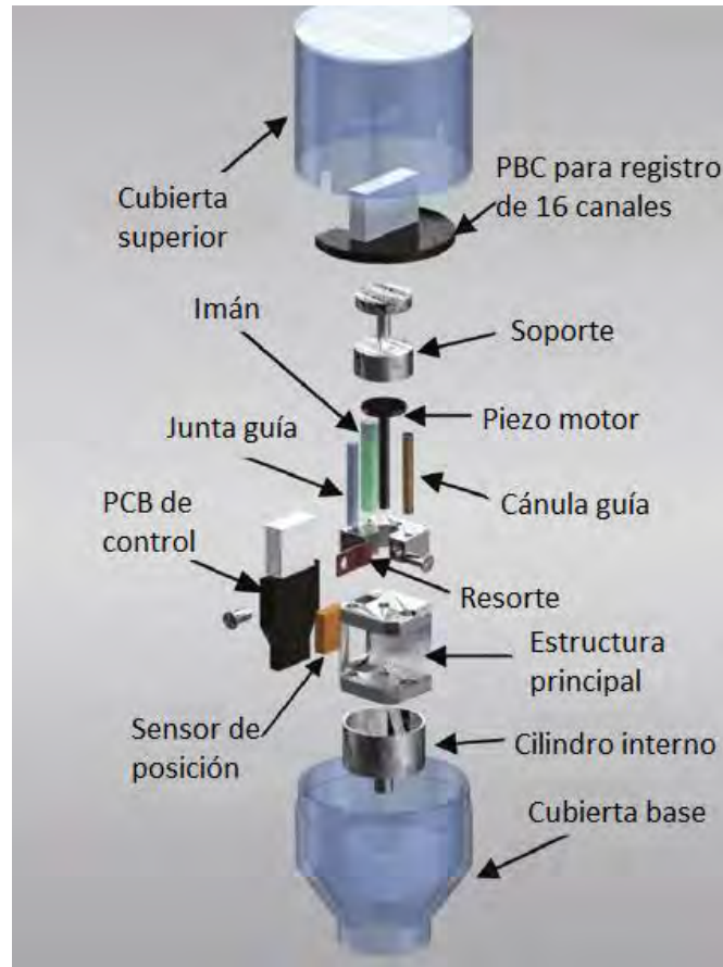
Figura 18. Microdrive motorizado basado en el principio piezoeléctrico y sensor de efecto Hall. Korea 2011 [42].
