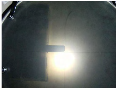
Figura 48. Orientación de la cánula proyectada en el sistema de referencia del proyector de perfiles NIKON Profile Projector V-16D
