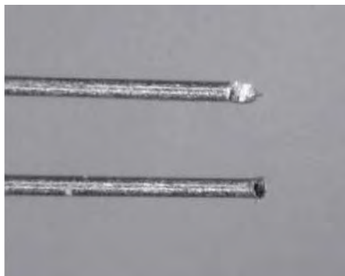
Figura 4. Configuraciones de la punta de los electrodos usada en Nicolelis Lab [20]. En la parte superior corte en ángulo y en la parte inferior corte recto.
