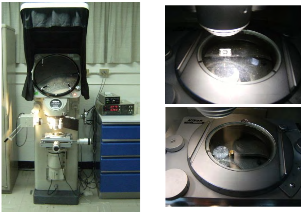
Figura 36. Medición de piezas fabricadas con el proyector de perfiles NIKON Profile Projector V-16D (Laboratorio de Metrología CCADET).
