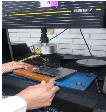
Figura 39. Colocación y ajuste de la placa de medición.
