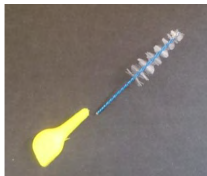
Figura 42. Vástago desprendido del mango.
