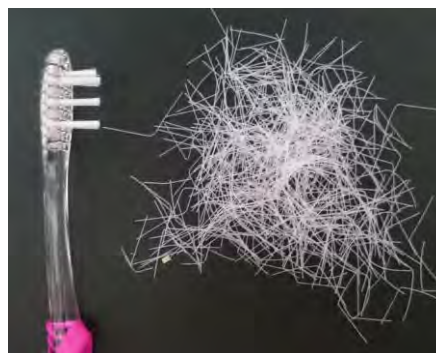
Figura 23. Cepillo Oral-B después de cortar los penachos necesarios para realizar la prueba.
