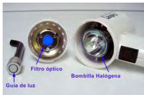
Figura 20. Partes de una lámpara de luz de halógeno. 11
