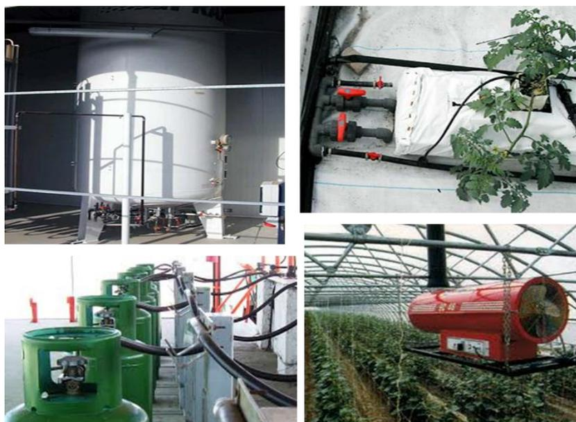
*Fig. 3. 12 Principales sistemas para la generación de bióxido de carbono*
