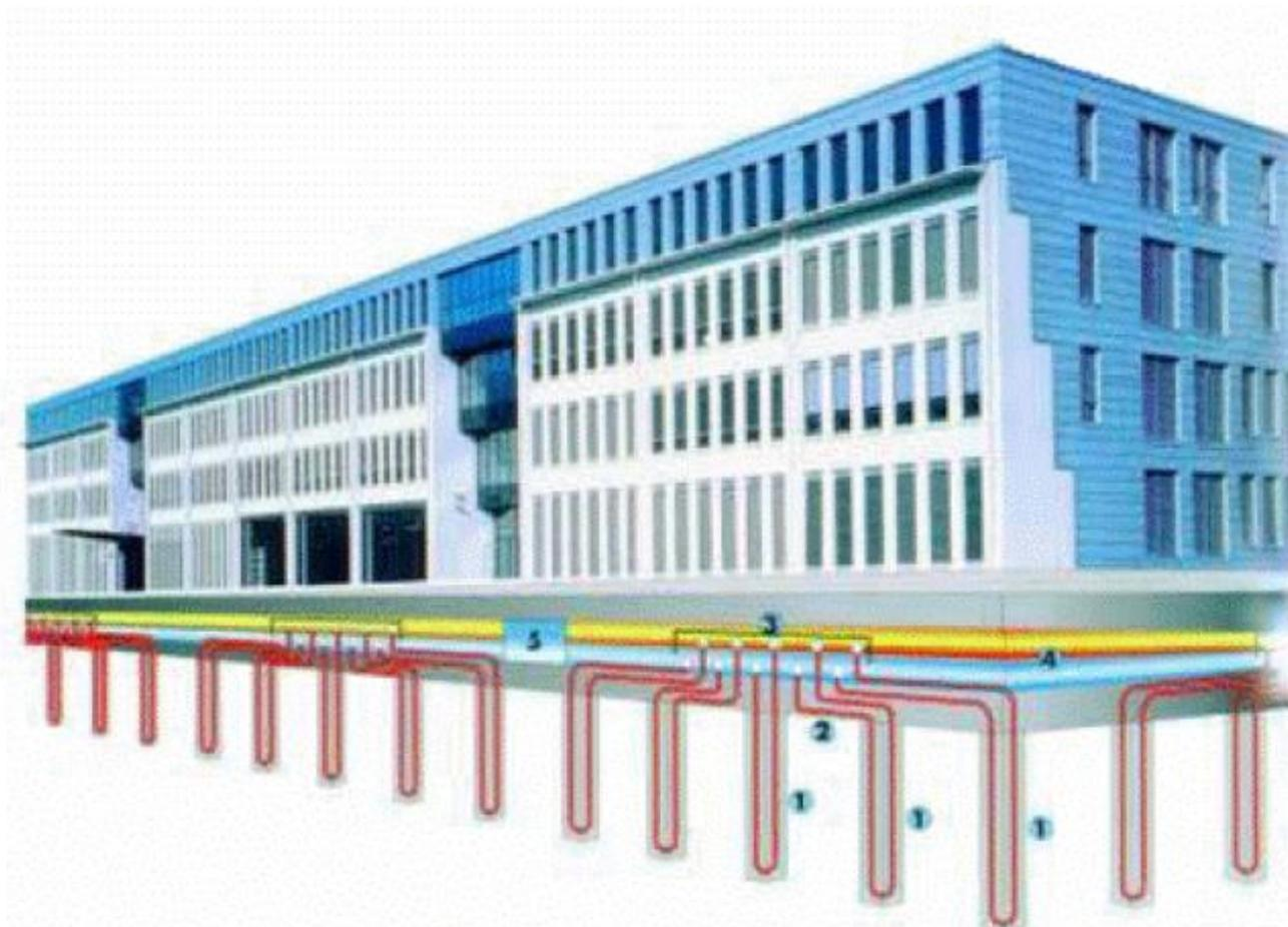
*Fig. 1. 19 Esquema de un edificio con pilotes intercambiadores de calor [2]*
