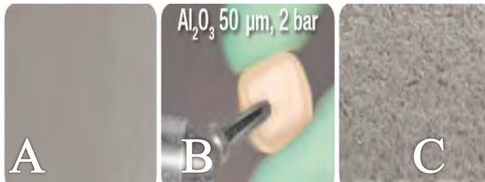
**Fig. 20 Superficie de la zirconia al microscopio A) Antes de arenado. B) Arenado con óxido de aluminio a 2 bares de presión. C) Después de arenado.**
