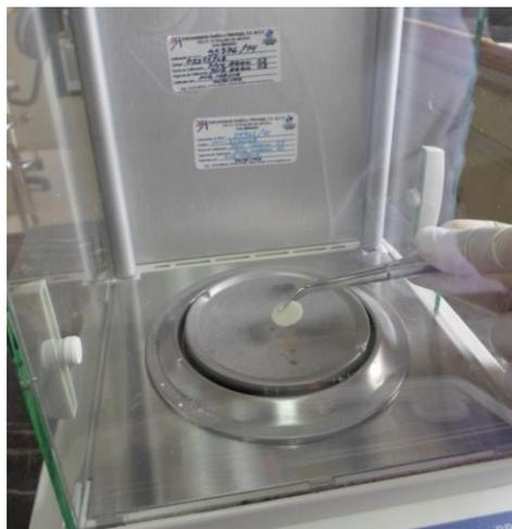
Fig XXXVII. Manejo de las muestras con pinzas de curación evitando contaminación.
