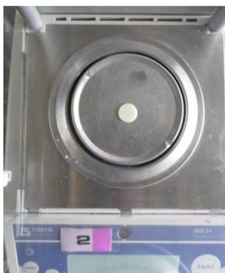
Fig XLII Pesado de las muestras para obtener m3.
