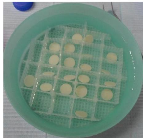
Fig XXXIX. Recipiente con agua tipo II, con red plástica y muestras.
