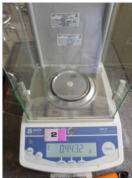
Fig XL Aire comprimido en lata, desecador, recipiente con agua bidestilada y las muestras, (Izquierda). Balanza analítica pesando obteniendo m<sub>2</sub>. (derecha).
