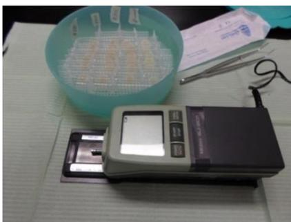
Fig XLIII. Perfilómetro y muestras secas en el recipiente, con una red para evitar fricción entre éstas
