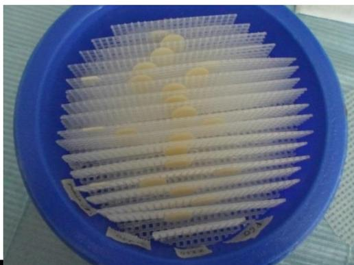
Fig XXXIII. Desecador con red de plástico y las muestras colocadas, evitando la fricción entre ellas.
