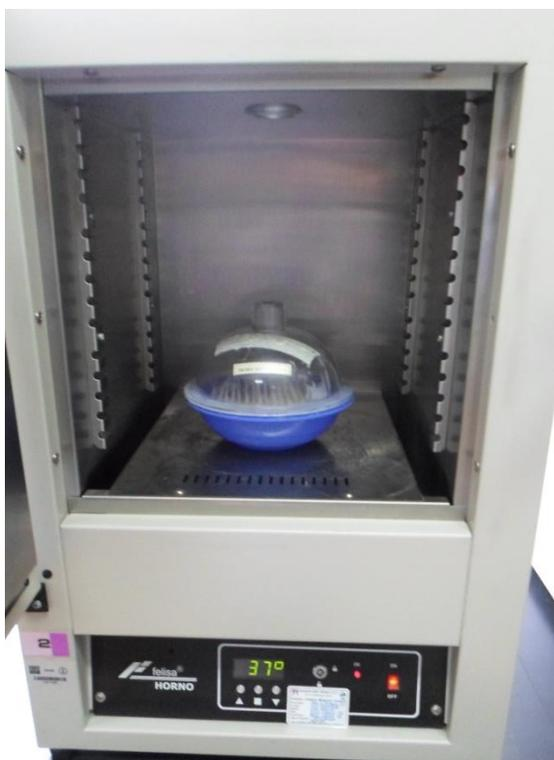
Fig. XXXV. Desecador sellado y colocado en el horno a temperatura de  $37^{\circ}\text{C}$ .
