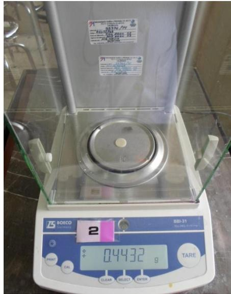
Fig XXXVI. Balanza analítica pesando la muestra.
