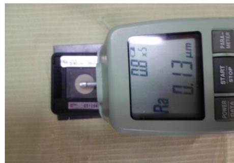
Fig XLVII Medición de tersura superficial.
