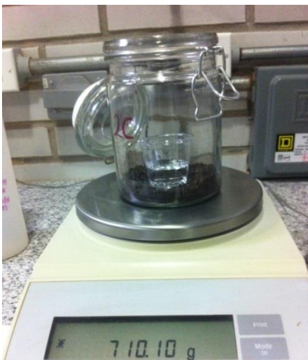
Figura 10. Colocación de 20ml de NaOH 0.5N en el interior del frasco hermético
