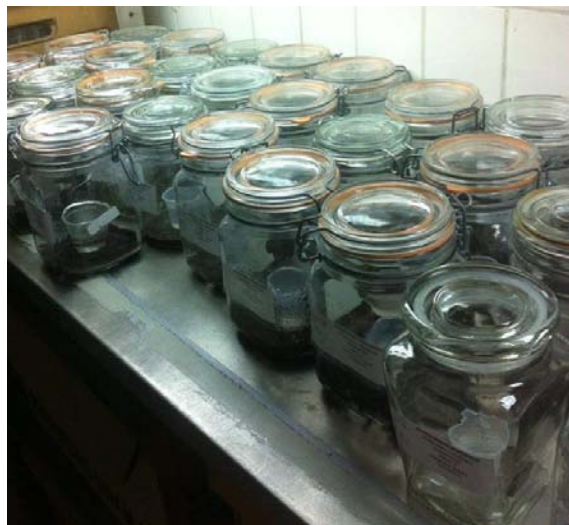
Figura 11. Incubación de las unidades experimentales a temperatura constante de 25°C
