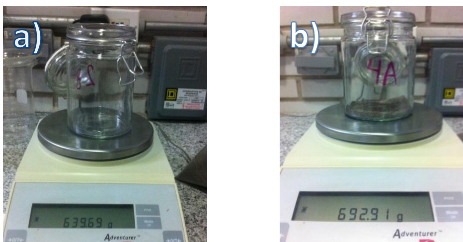
Figura 8. Frascos de vidrio con cierre hermético(a) donde se colocaron 25.0g de suelo en peso seco (b).
