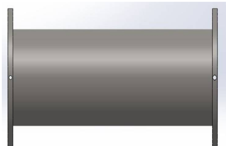
Figura 8. Cilindro y bridas soldables
