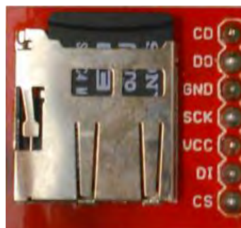
Figura 11: Slot de la memoria micro-SD.
