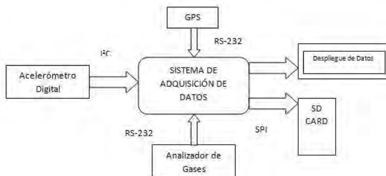
Figura 9: Diagrama de bloques del SAD.
