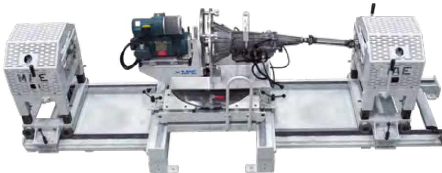
Figura 15: Ejemplo de un dinamómetro de banco.
