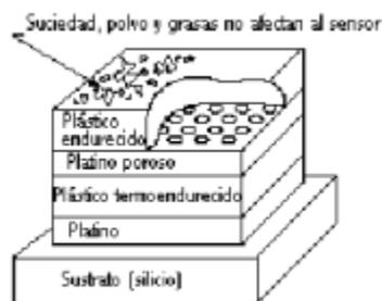
**Figura 2.4.9. Sensor Capacitivo.**
