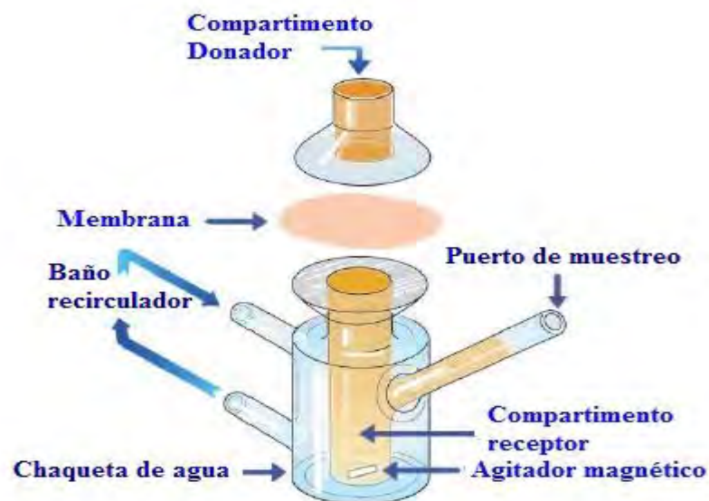
Figura 3.5a. Imagen de composición de una celda de Franz. Imagen tomada y modificada de referencia [66].
