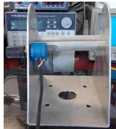
Figura A.3 Potenciómetro en la primera base de los eslabones
