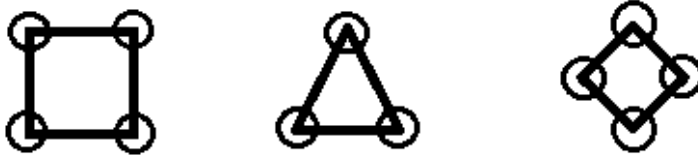
Figura 4.10 Arreglo de tubos para intercambiadores de calor
