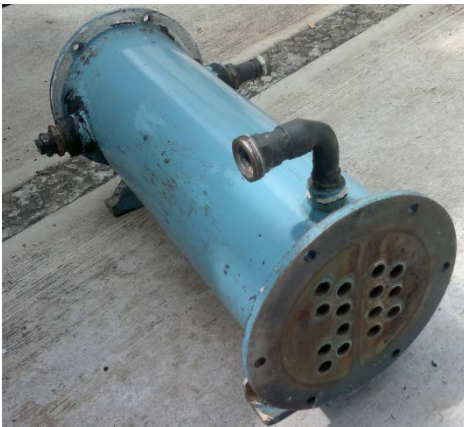
Figura 4.22 Equipo absorbedor existente del sistema de Aire Acondicionado Solar
