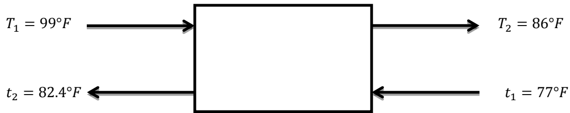
Figura 4.7 Temperaturas de entrada y salida del Absorbedor.
