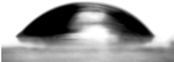
Figura 88.- Ángulo de contacto de \text{CH}_3\text{NO} formado en la película "UV-M-OS-1"
