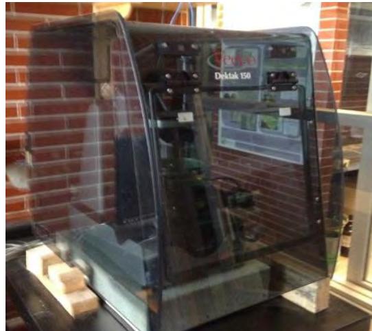
Figura 22.- Perfilómetro utilizado para medir los espesores de los recubrimientos
