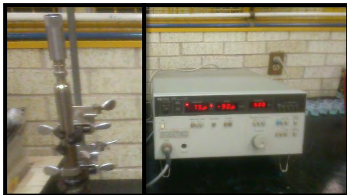
Figura 16. Izq celda de medición, Der. Equipo de medición del vector de impedancia marca HP modelo HP4193A.
