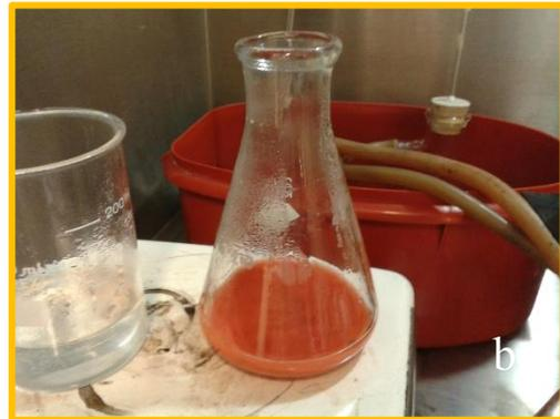
Fig. 19 a) Reactivos de Fehling, b) Precipitación de óxido de cobre
