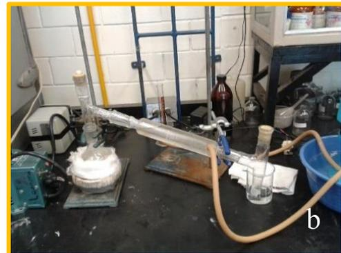
Fig. 18 a) Digestor Kjeldahl, b) Sistema de destilación
