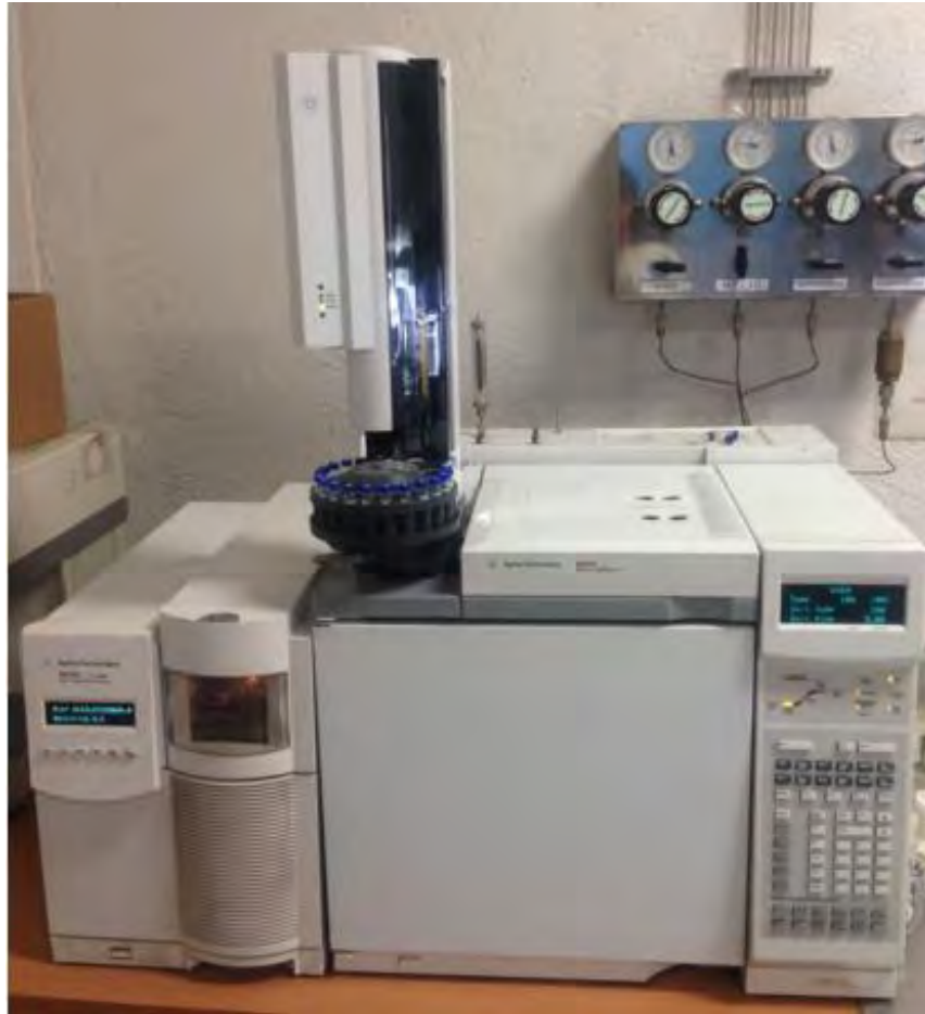
Figura B2. Cromatógrafo de gases acoplado a masas.
