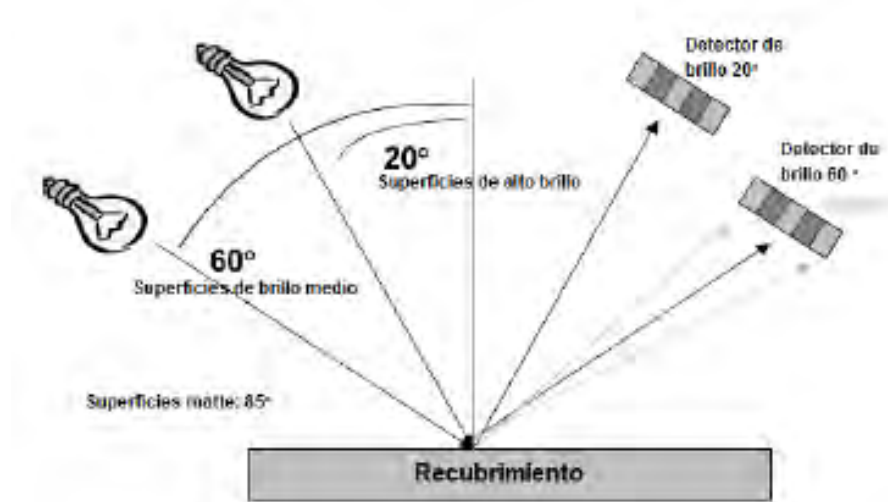
Figura B3. Principio de medición de brillo.
