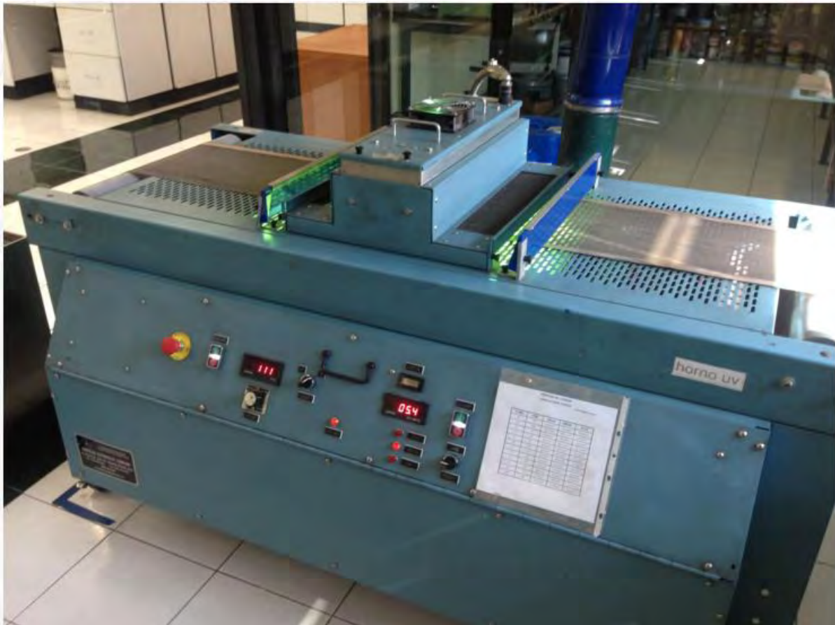
Figura 2.5. Equipo empleado en el proceso de curado.
