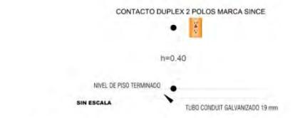
**SALIDA DE CONTACTOS REGULADOS EN MUROS**
