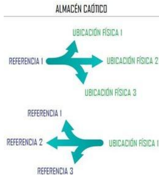
Figura 8. Concepto de Almacén Caótico 7 . A cada insumo (referencia), le pueden corresponder varias ubicaciones en el almacén.
