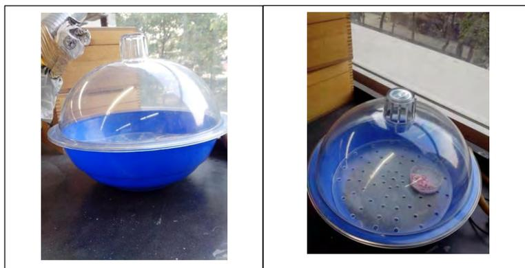
**Fig. 2-4** A la izquierda: desecador. A la derecha: Catalizador dentro del desecador durante el primer secado.
