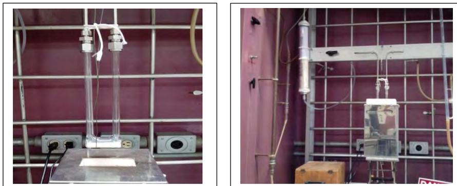
Fig. 2-6 (Izq.) Catalizador dentro del calcinador. (Der.) Proceso de calcinado dinámico.
