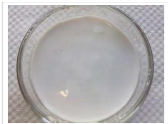
Fig. 2-1 Determinación del volumen de impregnación incipiente. Formación del espejo de agua.
