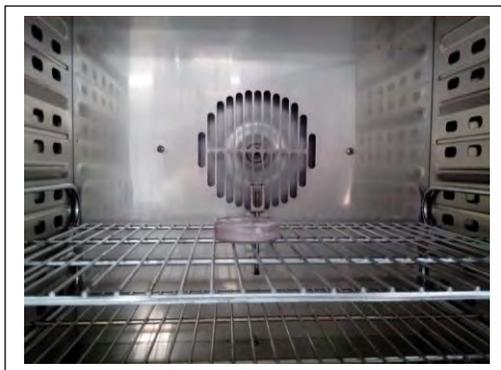
**Fig. 2-5 Catalizador dentro de la estufa durante el segundo secado.**
