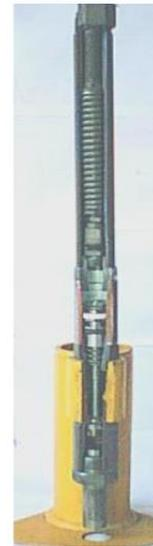
Fig. 3.3.2 Válvula Convencional para flujo Intermitente
