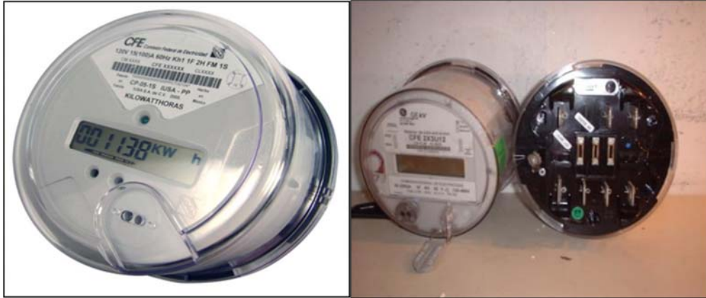
Ilustración 33medidor de estado sólido (usan circuitos integrados)
