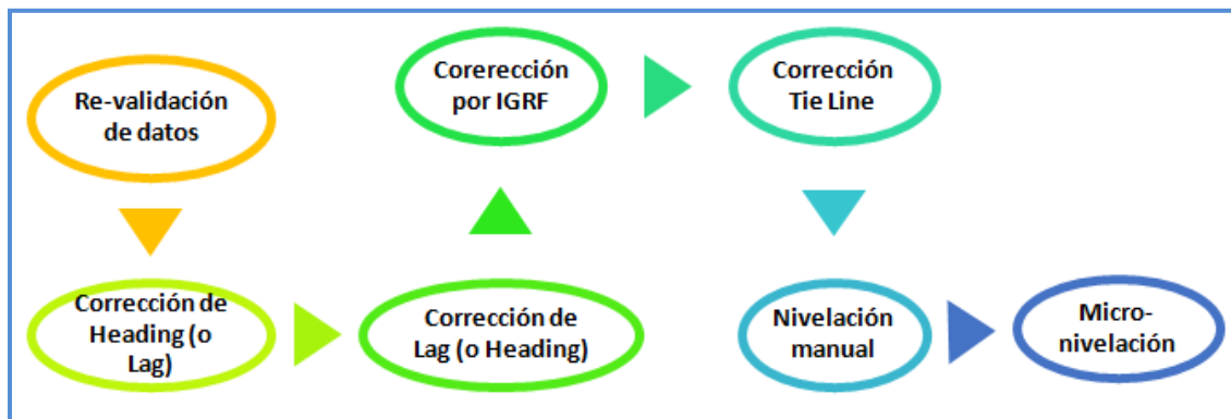
Figura 2.10. Diagrama que muestra la metodología aplicada en el procesamiento de datos aeromagnéticos.
