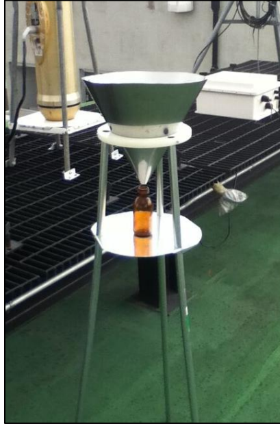
Figura 12. Equipo colector de agua de lluvia para la toma de muestras.
