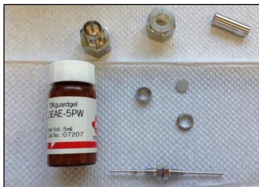
Figura 8. Piezas de guardacolumna o precolumna y solución para empacar.
