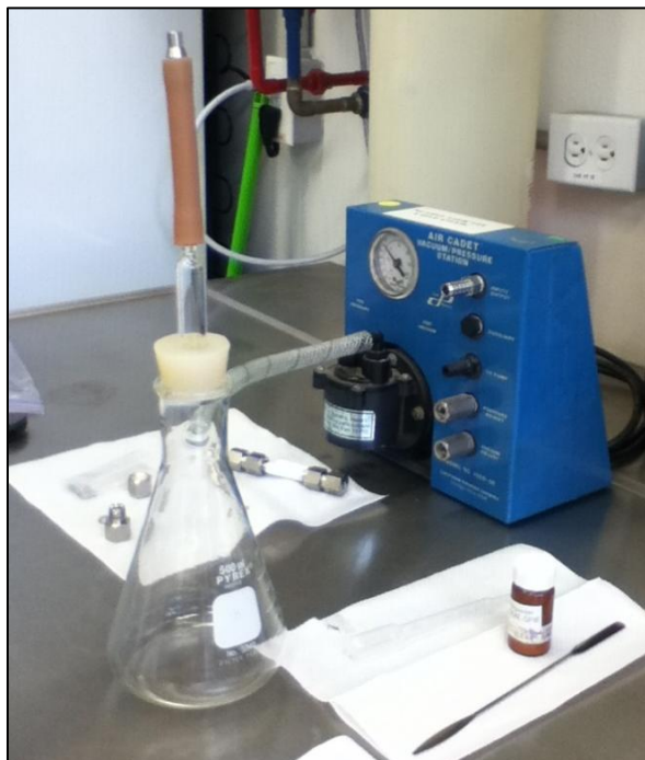
Figura 9. Proceso de empaque precolumna.
