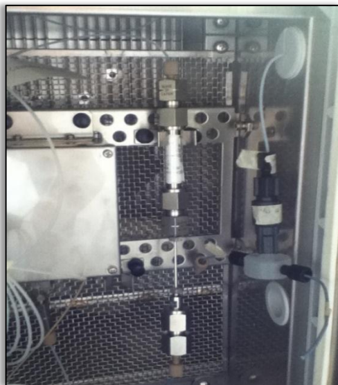
Figura 7. Columna: TSKgel DEAE-5PW y Precolumna: TSKguardgel DEAE-5PW.
