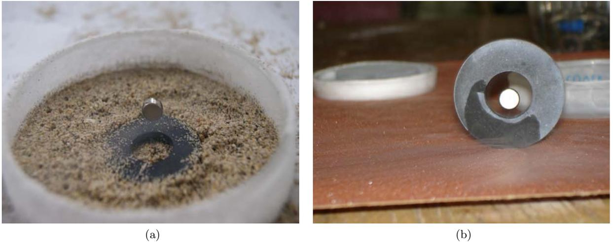
Figura 2.1.11: *Levitación de un imán de Neodimio. a) Efecto Meissner en el arillo superconductor de  $Y_1Ba_2Cu_3O_{7-\delta}$ , en un baño de nitrógeno líquido y arena. b) Efecto Meissner en el centro del arillo.*
