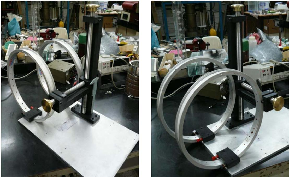
Figura 2.2.1: *Aparato posicionador sobre la placa de aluminio con bobinas de Helmholtz.*
