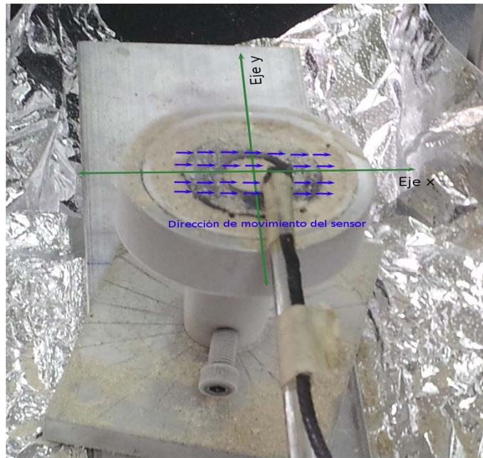
Figura 4.1.2: *Barrido horizontal del sensor Hall para mapear el campo magnético generado por el arillo superconductor.*
