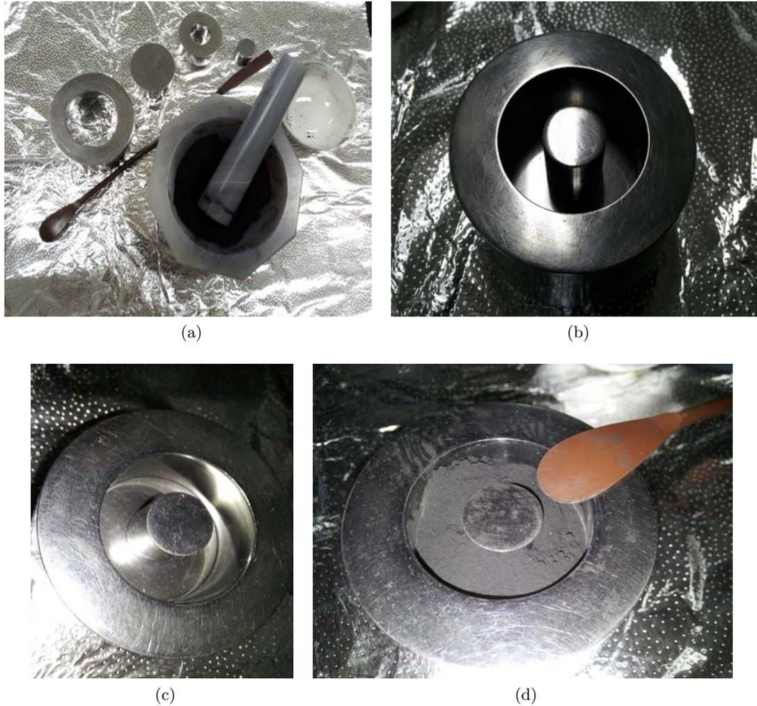
Figura 2.1.8: a) *Implementos para formar el arillo.* b) y c) *Arreglo de moldes.* d) *Polvo superconductor vaciado en el interior de los moldes.*
