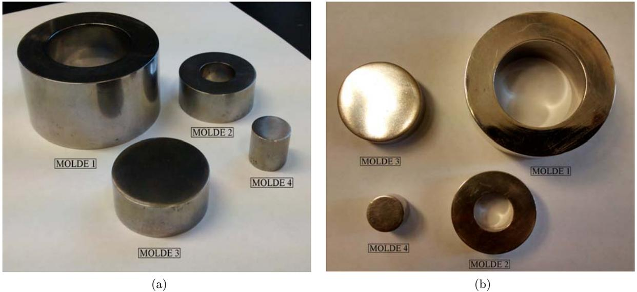
Figura 2.1.7: *Moldes utilizados para conformar el arillo superconductor de  $Y_1Ba_2Cu_3O_{7-\delta}$ . a) vista frontal. b) vista superior.*
