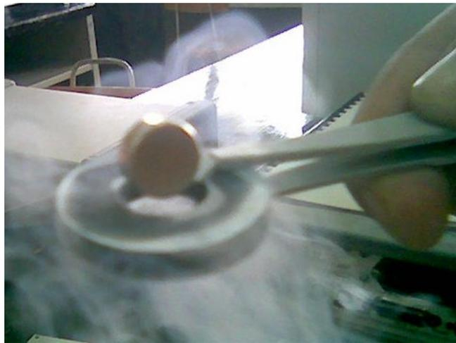
Figura 1.3.3: Levitación de un imán de neodimio debido al efecto meissner-Oschenfeld del arillo superconductor de  $Y_1Ba_2Cu_3O_{7-\delta}$ .
