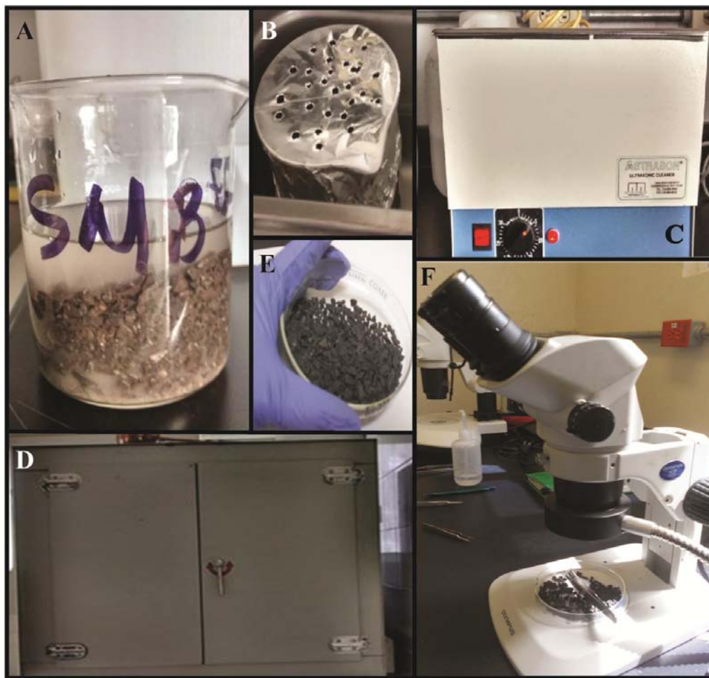
Figura 3.2. Proceso de lavado y limpieza de las muestras. A. Proceso de lavado de esquiras con agua desionizada, se nota como el agua sobre la muestra está turbia. B. Lavado de muestra en baño ultrasónico; es cubierta con papel aluminio para evitar que se contamine con polvo. C. Tina ultrasónica marca ASTRASON. D. Horno para secado de muestras. E. Muestra, previamente lavada y secada en el horno, en caja petri lista para limpiar bajo el microscopio. F. Limpieza de esquiras bajo un microscopio binocular.
