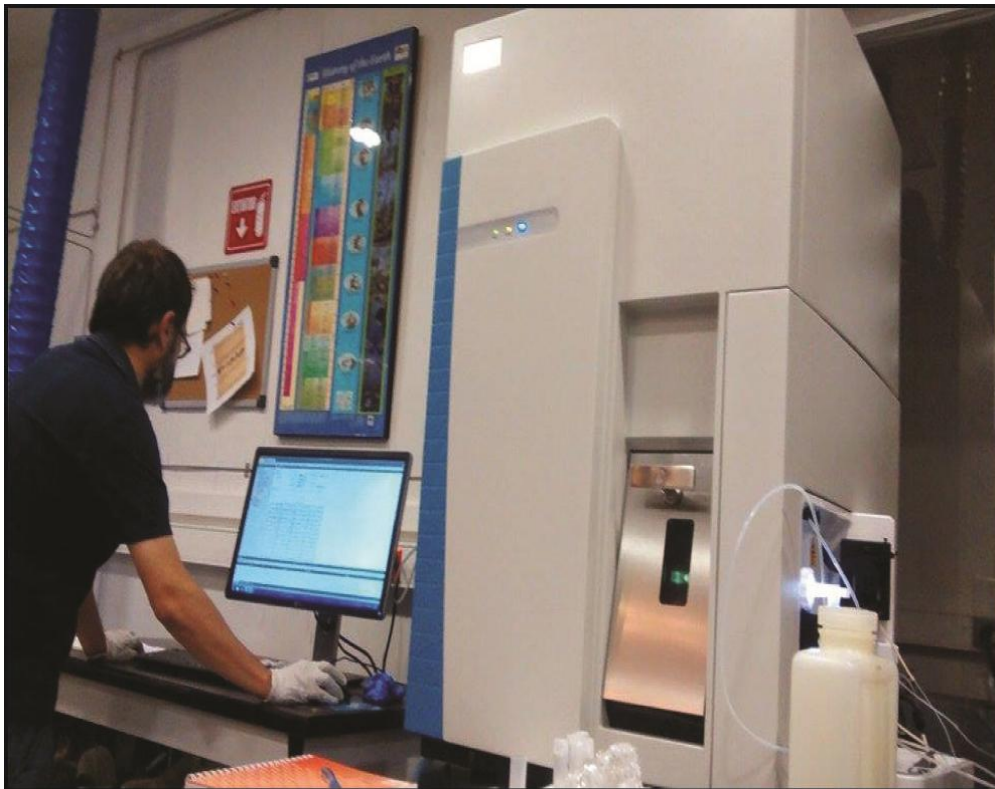
Figura 3.5 Análisis de muestras en el espectrómetro de masas con plasma de acoplamiento inductivo (ICP-MS), Thermo iCap Q del Centro de Geociencias (CGEO), UNAM.
