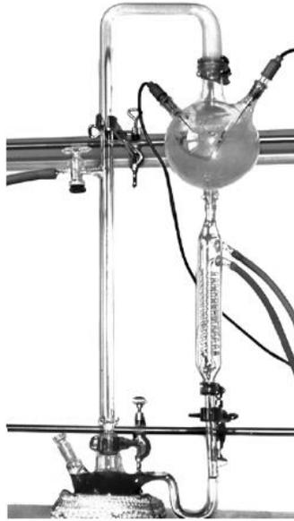
Figura 1. Equipo montado por Miller, en donde simuló las condiciones de la Tierra primitiva (tomado de (Follmann & Brownson, 2009)).
