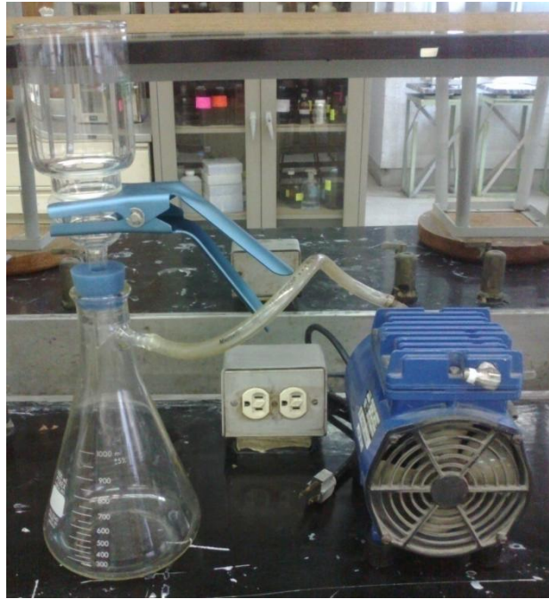
Figura 5. 4 Sistema de micro-filtración utilizado
