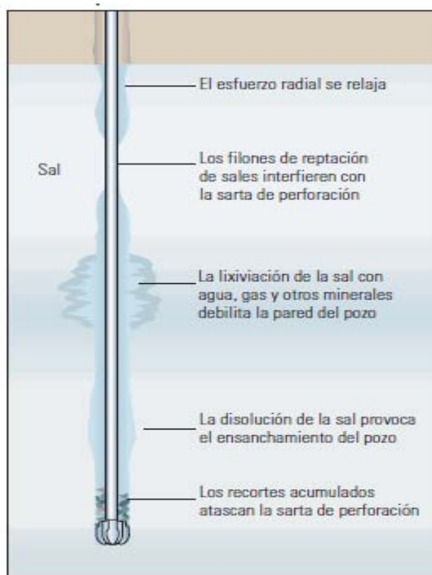
FIGURA 3.2. Riesgos al perforar la sal [Tomado de Aburto et al. , 2009].
