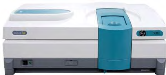
Figura 25 Equipo de espectrofotometría UV-vis para realizar los análisis de reflectancia difusa.
