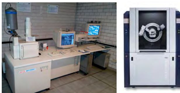
Figura 24 Equipo de microscopía electrónica de barrido con detector de energía dispersiva de rayos X y equipo de difracción de rayos X de la USAII.
