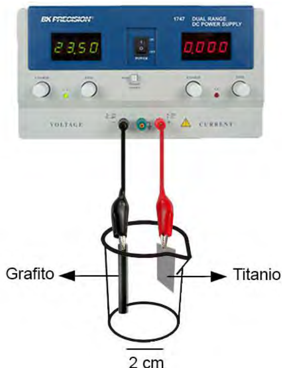
Figura 21 Sistema de anodización para las placas de titanio.
