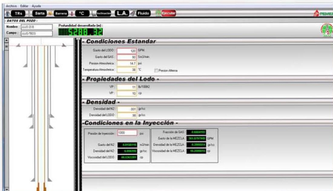
Figura 11. Simulador simplificado de la hidráulica de Perforación Bajo Balance.
