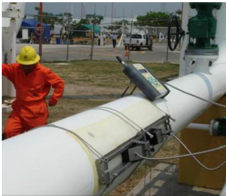
Ilustración 38. Medición de la cantidad de gas mandado a quema por medio de un medidor ultrasónico.
