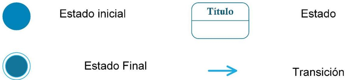
**Figura 4.1.3.13 Elementos de un diagrama de estado**
