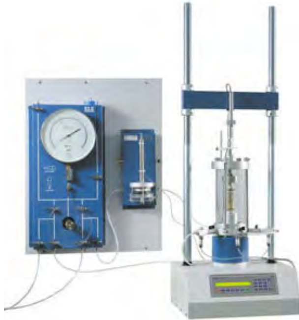
Figura 2. 1 Equipo triaxial. Fuente: www.ele.com/Category/soil-strength-triaxial/
