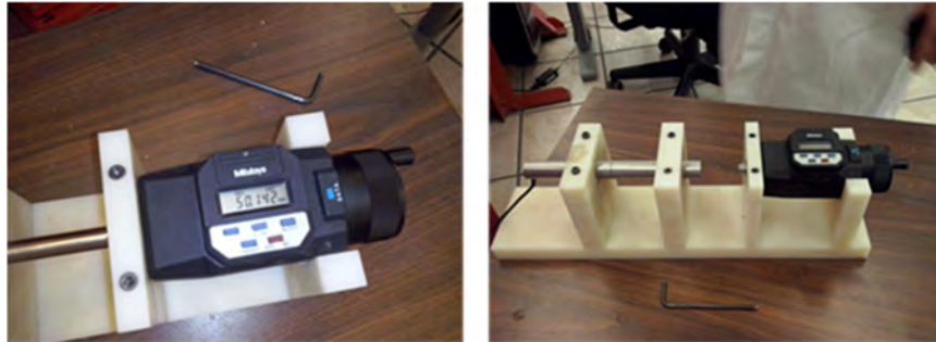
Figura 2. 10 Calibración del sensor de desplazamiento
