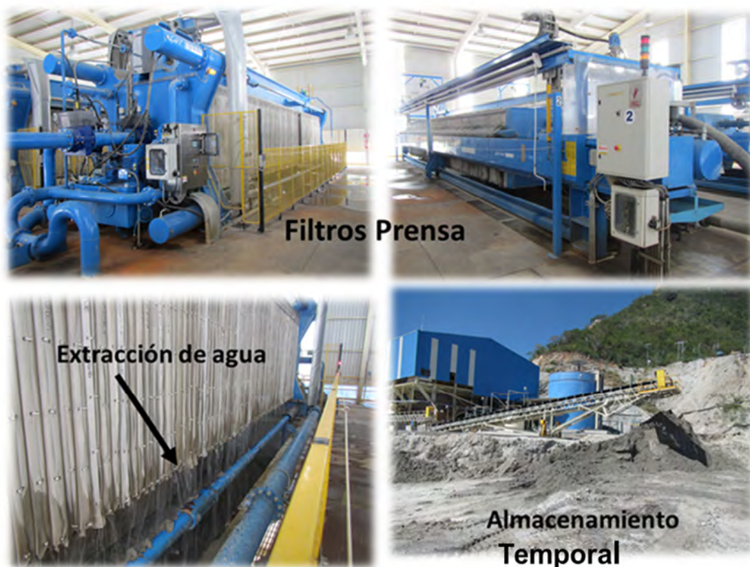
Figura 1. 4 Prensa para jales, Unidad Minera Bacís. San José de Bacís, Durango
