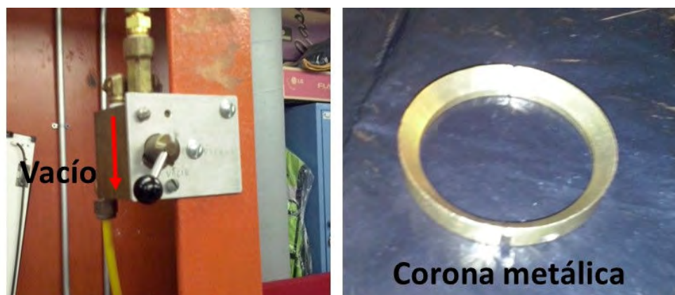
Figura 3. 16 Sistema de vacío y corona metálica
