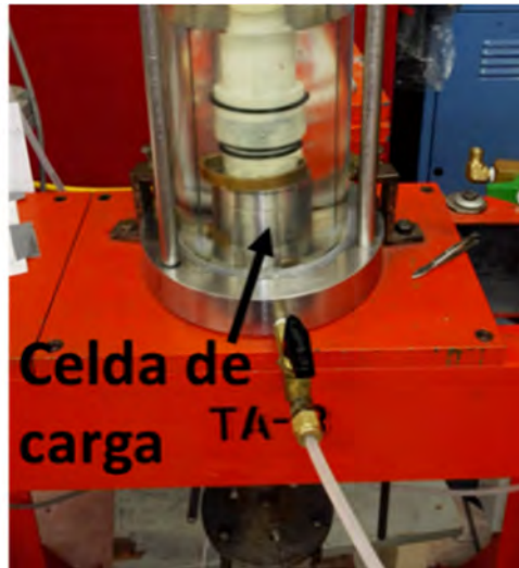
Figura 2. 12 Sensor de carga sumergible
