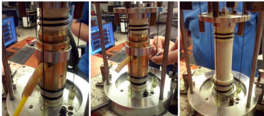
Figura 3. 21 Colocación de arosellos, desmolde y aplicación de vacío inferior.
