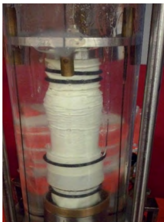
Figura 5. 5 Falla de probeta con características w=23\% , P_p=1500 g, \sigma_3=1.5 kg/cm 2 , e=0.8 , G_w=83\%
