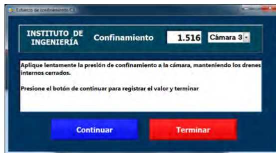
Figura 2. 19 Aplicación del esfuerzo de confinamiento
