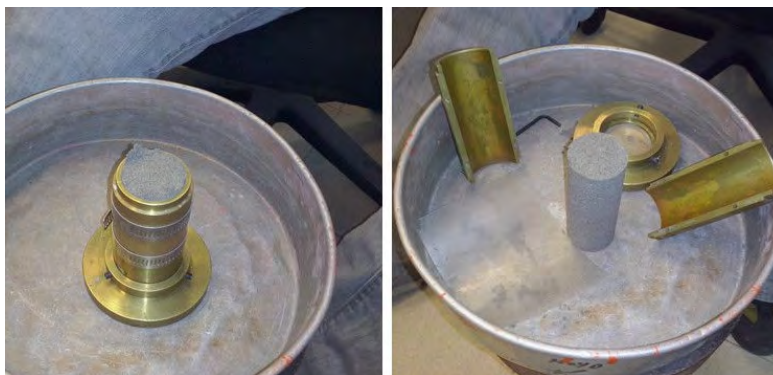
Figura 3. 8 Formación de probetas.
