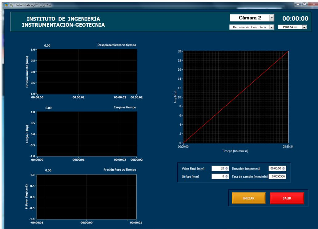
Figura 3.14: Módulo denominado “etapa de ensaye” del sistema de adquisición de datos
