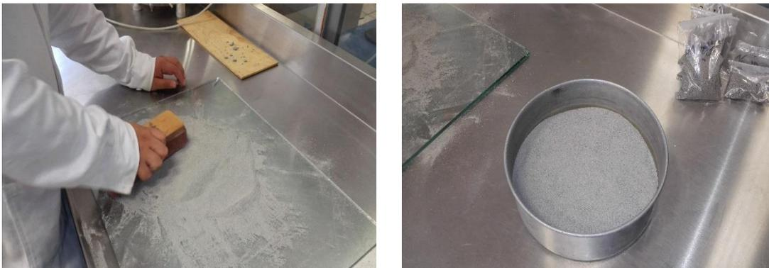
Figura 3.3: Homogeneización del material en seco
