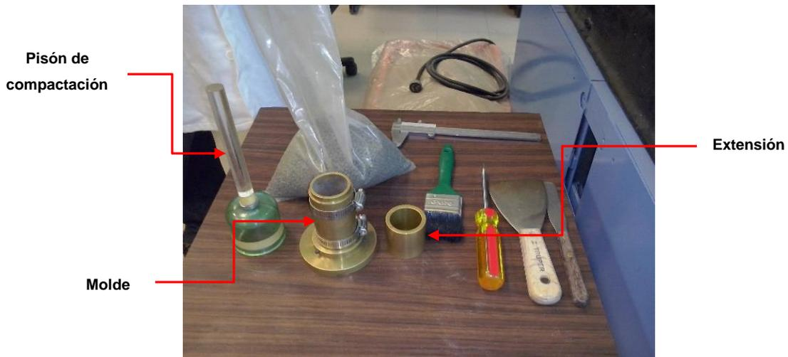
Figura 3. 6: Implementos utilizados para la formación de la probeta en pruebas de compactación
