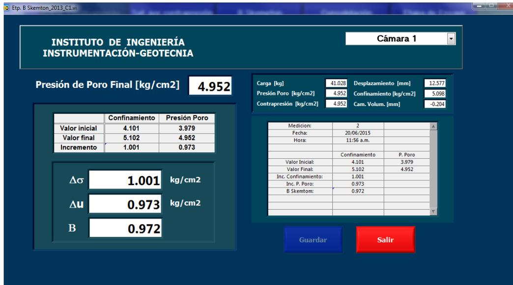
Figura 2.10: Medición del parámetro B de Skempton
