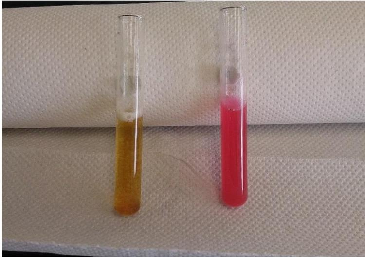
Figura 16. Prueba de identificación de níquel (II) en la solución A y C
