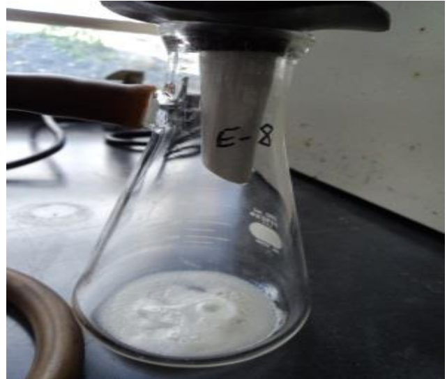
Foto # 2 Filtrado al vacío para obtener BHET
