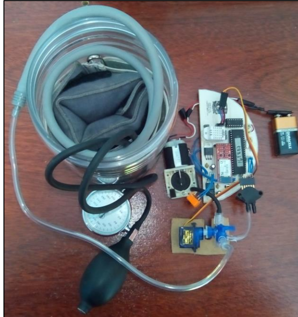
Figura 4.2. Modelo con simulación de un muñón mediante una bolsa de aire, listo para realizar las pruebas.
