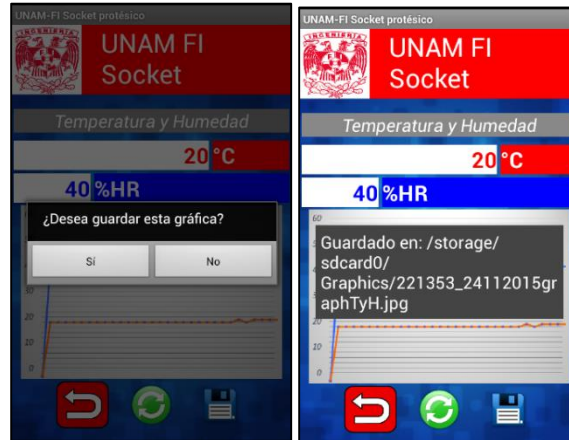
Figura 3.39. Almacenaje de los datos de temperatura y humedad.
