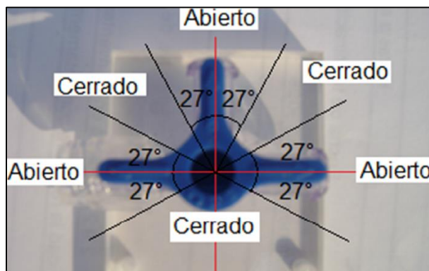
Figura 2.10. Posiciones angulares de la válvula en las que existe intersección de áreas [23].
