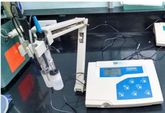
Figura 25. Potenciómetro
