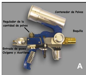
Fig. 2.4 Pistola de proyección térmica de polvos. [18]
