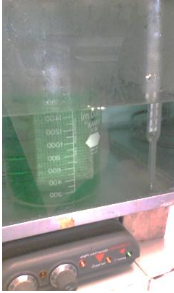
Fig. 2.13 Baño químico sumergido en el baño termorregulado durante la deposición del níquel.
