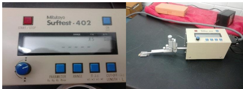
Fig. 2.3 Rugosímetro y disposición utilizada para el proceso de medición.
