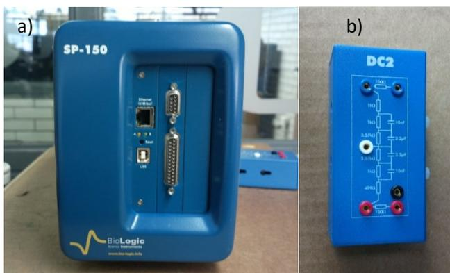
Ilustración 3-6 Potenciostato BioLogic SP 150 (a) junto con su (b) celda "dummy" para constatar que su funcionamiento sea el adecuado
