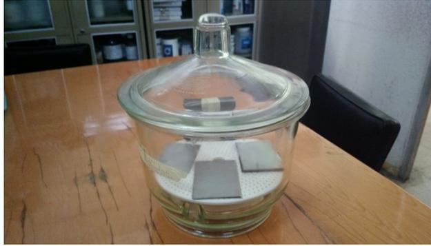
Ilustración 3-2 Probetas resguardadas de la humedad en el desecador.
