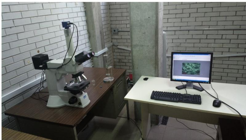
*Ilustración 3-10 Uso del microscopio óptico con interfaz a computadora para recabar imágenes en formato electrónico.*
