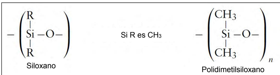
Figura 2.20 Estructura general del siloxano y del polidimetilsiloxano.
