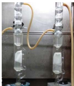
Imagen 14. Izquierda) Armado del equipo Soxhlet, Derecha) obtención del aceite de chía, [Fotografía de Miguel Ángel Romero Aguilar]. (LADEMA-UNAM Campo 1, Cuautitlán Izcalli, Edo. de México). Archivo del autor.
