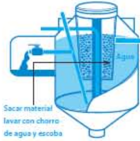
Limpieza del tanque
