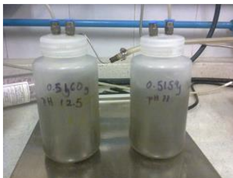
Figura 7 Diagrama de experimentos preliminares de oxidación, con aireación y agitación magnética constante
