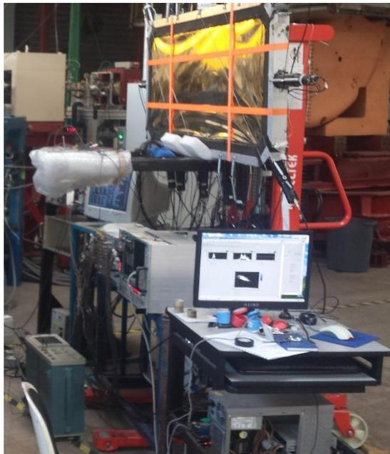
Fig. 3.11.1) MONDE con la nueva tarjeta PADC realizando toma de datos de radiación de fondo.
