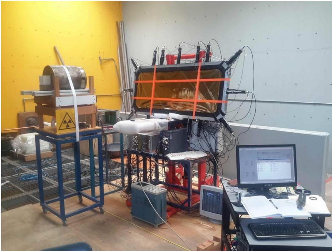
Fig. 3.7.1) Montaje Experimental de los experimentos 3.6 y 3.7, en el experimento 3.7 se colocó una fuente de Am-Be en el blindaje.
