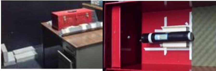
Fig. 3.8.2) Derecha: tubo fotomultiplicador con el cristal NaI dentro de la caja de herramientas. Izquierda: Caja de herramientas dentro del cuarto oscuro del Laboratorio de Radiaciones, esta caja funge también como una caja de Faraday aislando los fotomultiplicadores de radiaciones que pudieran afectar su funcionamiento.
