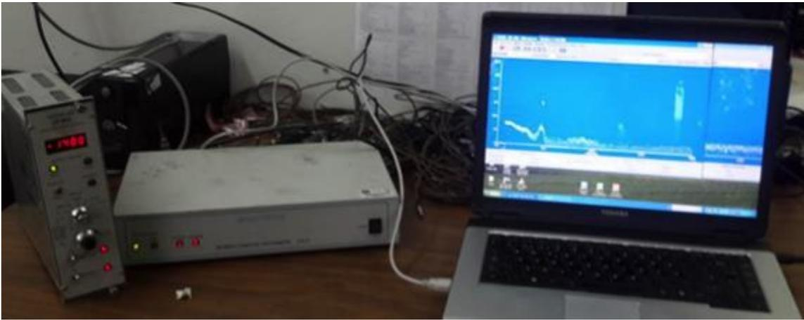
Fig. 3.8.6) Montaje del sistema de adquisición de datos y fuente de alto voltaje para las pruebas de los tubos fotomultiplicadores.
