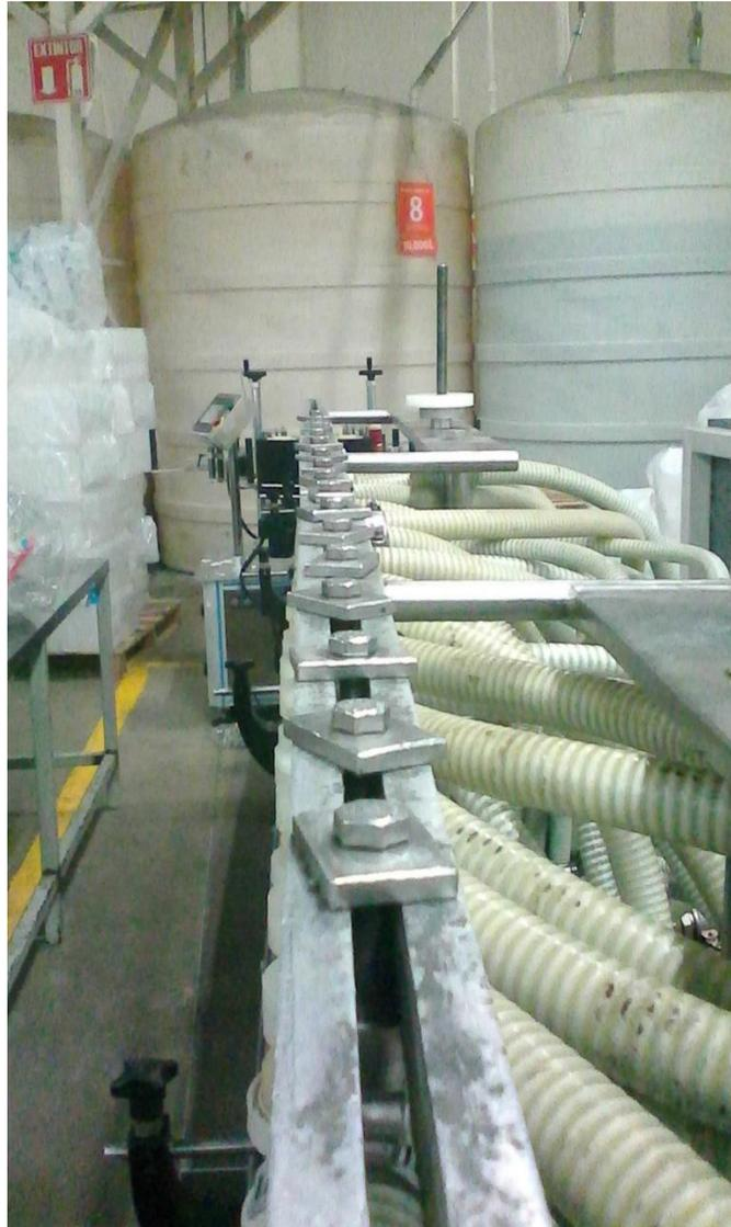
*Figura 36. Inclusión de placas de acero inoxidable para mejorar el centrado de las boquillas.*
