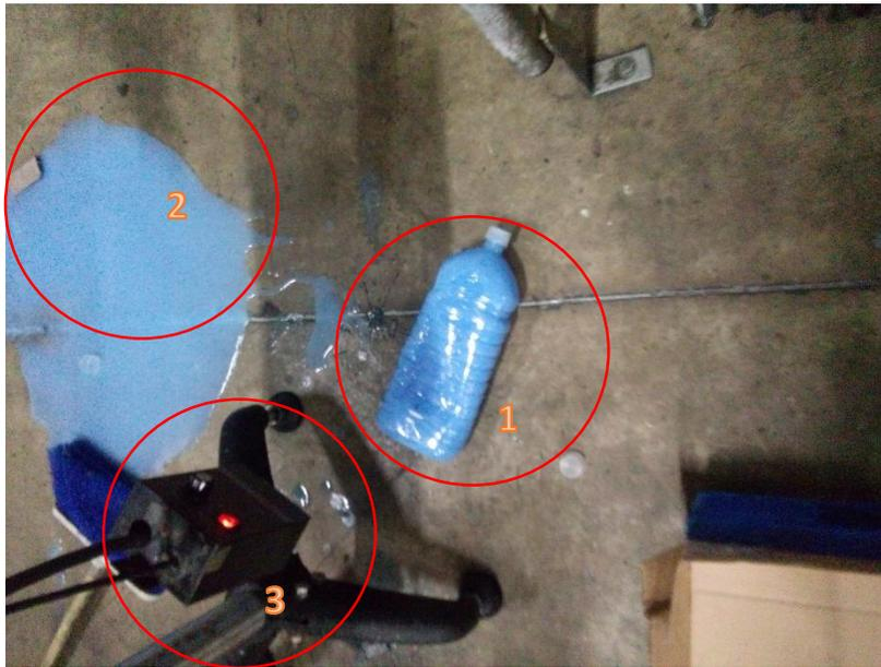
Figura 17. Envase dañado por guías en mal estado.
