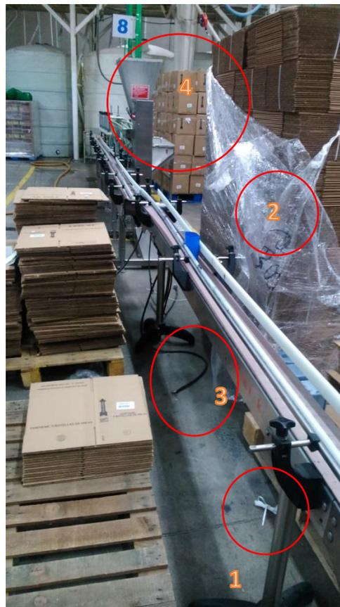
*Figura 20. Materiales fuera de lugar, equipos dañados y falta de limpieza.*
